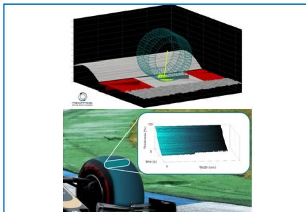
Virtualizzazione di uno pneumatico motorsport per le simulazioni real-time e la predizione delle performance e dell'usura
