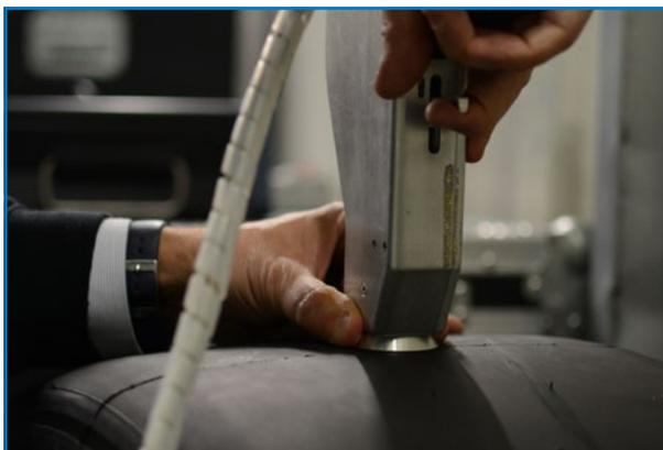
Test su pneumatici racing mediante il VESevo
