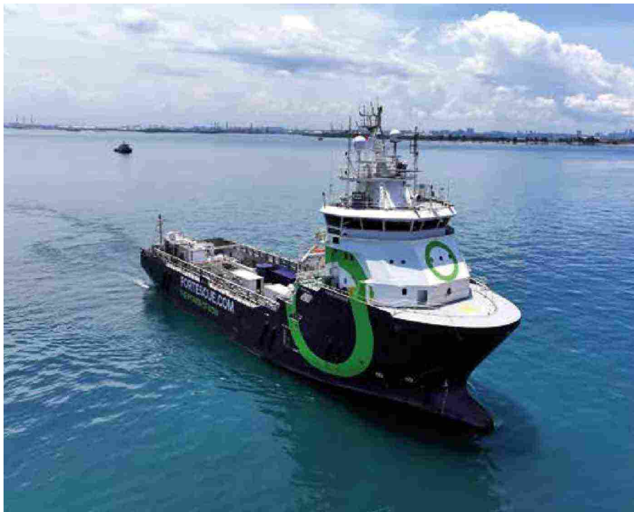
Green Pioneer di Fortescue combina motori diesel con un sistema di propulsione ad ammoniaca. Trasporta minerali ferrosi.
